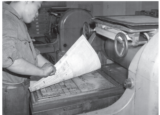
図26 （上）チェースに活字を組むところ（手前）と紙型を作るためのプレス工程（下）プレス後、紙型を剥がすところ（山形新聞社、1979年11月30日撮影）
