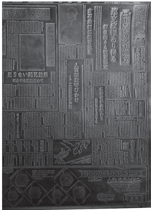
図25 山形新聞の紙型（左）・鉛版（右上）・チェースと大組み（右下） （山形新聞社印刷センター所蔵）
